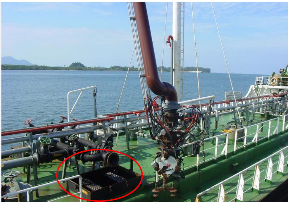
รูปที่ ข.1-5 ภาพขณะรองรับน้ำมันที่อาจรั่วไหลจากข้อต่อในเรือกับ Loading Arm
